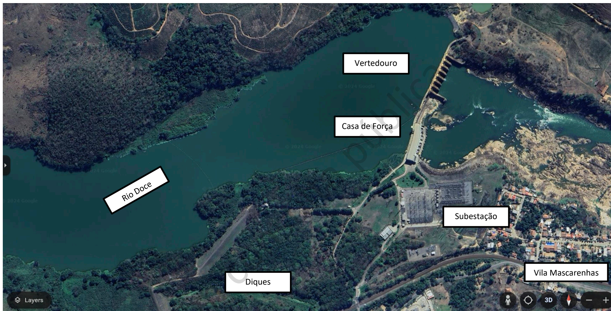
Figura 1 – Visão geral da UHE Mascarenhas, mostrando o Rio Doce fluindo da esquerda para a direita, o reservatório com sua zona de amortecimento bem vegetada, duas barragens de sela - diques na margem esquerda, a barragem principal com um vertedouro à esquerda, a barragem central e a casa de força à direita, a subestação diretamente ao sul da casa de força, os trilhos da ferrovia (operados pela mineradora Vale S.A.) e a vila original de Mascarenhas, que foi expandida durante a construção da UHE.
